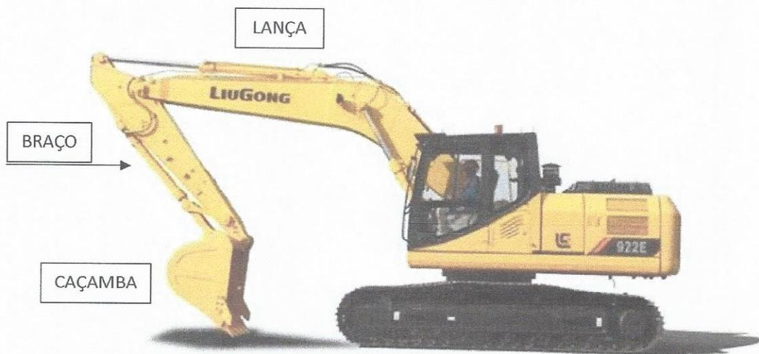
A escavação da máquina é realizada conforme sua capacidade de exercer pressão sobre o solo e essa capacidade é influenciado por vários fatores, como o *nível de estabilidade da máquina* (permitindo o uso total de sua força), a *experiência* do operador do equipamento e o tipo de solo ou material a ser escavado (areia, saibro, argilo, pedregulho, etc).
